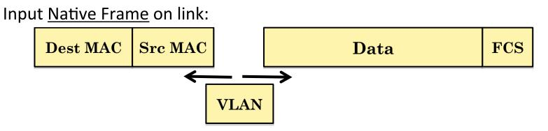
Input port adds VLAN-ID and priority if frame untagged
